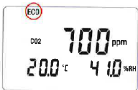
Figur 3. Display då ECO mode är aktiverat.
