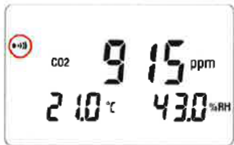
Figur 7. Display när instrumentet har aktiverad larmfunktion.
