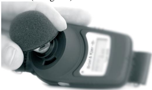
Figur 3. Demontering av mikrofonvindskyddet.
