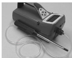
Bild 8. Infästning av teleskopsonden på instrumentet.
