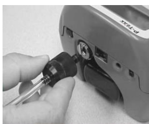
Bild 7. Montering av anslutningsadapter.
