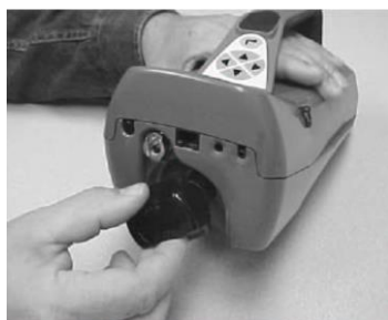
Bild 6. Isättning av alkoholpatronen i P-TRAK.
